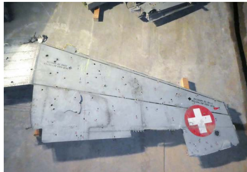
Tragfläche eines Flugzeugs von Projektile durchgelöchert.
